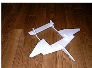
切り出した部品を画像のように組み立てて下さい。組み立てたら各部品を木工用ボンドで固めます。
